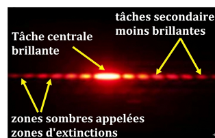
Figure 2 – Figure de diffraction observée sur l'écran
